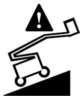
Wenn der Neigungsalarm bei angehobener Plattform ausgelöst wird, leuchtet die Anzeigelampe. Maschine nicht waagrecht auf, und die Fahrfunktionen in eine oder beide Richtungen können nicht angesteuert werden. Ermitteln Sie wie unten gezeigt den Zustand des Auslegers auf dem abschüssigen Gelände.
