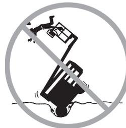
Mit äußerster Vorsicht und niedriger Geschwindigkeit vorgehen, wenn die Maschine mit abgesenktem Ausleger über unebene, instabile, schuttbedeckte oder rutschige Flächen oder in der Nähe von Gräben oder Abhängen fahren muss.
