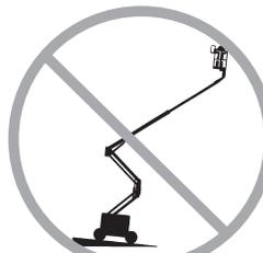
Der Ausleger darf nur angehoben oder ausgefahren werden, wenn die Maschine auf festem, ebenem und waagrechttem Untergrund steht.
