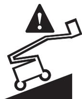
Wenn der Neigungsalarm bei angehobener Arbeitsbühne ausgelöst wird, beginnt die Kontrollleuchte "Maschine nicht waagrecht" zu leuchten und die Fahrtfunktion ist in einer oder beiden Richtungen nicht möglich. Den Zustand des Auslegers auf abschüssigen Gelände ermitteln, wie unten beschrieben.
