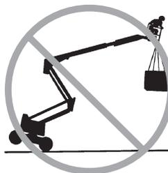
Keine fixen oder überhängenden Lasten auf irgendeinem Teil der Maschine platzieren bzw. befestigen.
