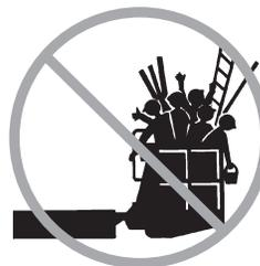
Keine Leitern oder Gerüste auf der Arbeitsbühne verwenden, und Leitern oder Gerüste nicht an der Maschine abstützen.
