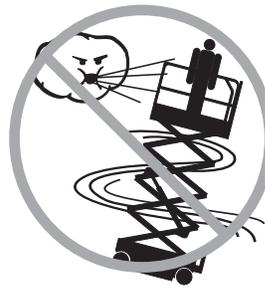
Nehmen Sie die Maschine bei starkem oder böigem Wind nicht in Betrieb. Die Fläche der Plattform oder der Ladung darf nicht vergrößert werden. Wenn die dem Wind ausgesetzte Fläche vergrößert wird, wird die Stabilität der Maschine beeinträchtigt.
