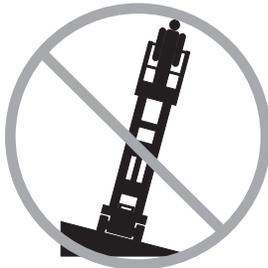
Überprüfen Sie, ob die Maschine waagrecht steht, und verlassen Sie sich nicht auf den Neigungsalarm. Der Neigungsalarm am Fahrgestell ertönt nur, wenn die Maschine auf einer stark abschüssigen Fläche steht.
