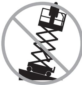
Achten Sie beim Anheben der Plattform stets darauf, dass sich die Maschine auf einem festen, ebenen und horizontalen Untergrund befindet.
