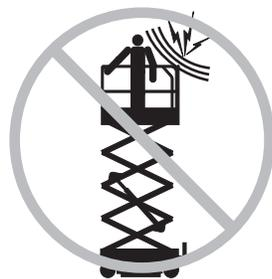
Halten Sie sich fern von der Maschine, wenn sie Strom führende Leitungen berührt. Personal am Boden oder auf der Plattform darf die Maschine so lange nicht berühren oder in Betrieb nehmen, bis die Strom führenden Leitungen abgeschaltet sind.
