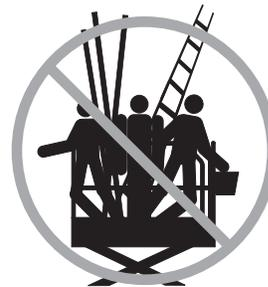
Verwenden Sie keine Leitern oder Gerüste auf der Plattform, und stützen Sie Leitern oder Gerüste nicht an der Maschine ab.
