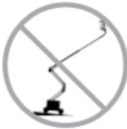
Der Ausleger darf nur angehoben oder ausgefahren werden, wenn die Maschine auf festem, ebenem und waagrechttem Untergrund steht.
