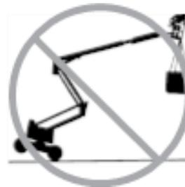
Platzieren bzw. befestigen Sie keine fixen oder überhängenden Lasten auf irgendeinem Teil der Maschine.
