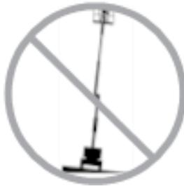
Überprüfen Sie, ob die Maschine waagrecht steht, und verlassen Sie sich nicht auf den Neigungsalarm. Der Neigungsalarm auf der Plattform ertönt nur, wenn die Maschine auf einer stark abschüssigen Fläche steht.
