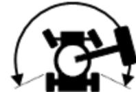
Halten Sie zum Fahren den Schalter Antriebsaktivierung nach links oder rechts gedrückt, und bewegen Sie langsam den Steuerhebel Fahren aus der Mittelstellung.
