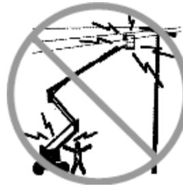
Halten Sie sich fern von der Maschine, wenn sie Strom führende Leitungen berührt. Personal am Boden oder auf der Plattform darf die Maschine so lange nicht berühren oder in Betrieb nehmen, bis die Strom führenden Leitungen abgeschaltet sind.
