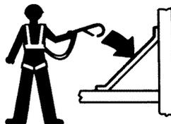
Personen auf der Arbeitsbühne müssen Sicherheitsgurte bzw. die den behördlichen Bestimmungen entsprechende Ausrüstung tragen. Befestigen Sie die Sicherungsleine an der dafür vorgesehenen Verankerung auf der Plattform.
