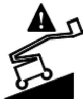
Die leuchtende Lampe weist darauf hin, dass die Maschine nicht waagrecht steht. Der Neigungsalarm ertönt, wenn diese Lampe leuchtet, und auf dem LCD-Display auf dem Plattformsteuerpult erscheint die Meldung MACHINE IS NOT LEVEL (MASCHINE STEHT NICHT WAAGERECHT). Fahren Sie die Maschine auf einen festen und waagerechten Untergrund.
