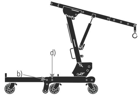
7. Führen Sie den Bolzen c) in die Bohrung d) und sichern Sie ihn.
