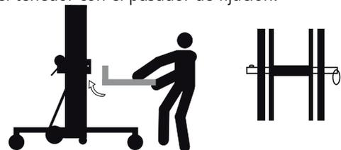
3. Ajustar el ancho de los tenedores y comprobar la conexión para cada pasador adjunto.
