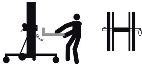
3. Réglez la largeur désirée de la fourche et assurez-vous que les goupilles de serrage sont correctement insérées dans la fourche.
