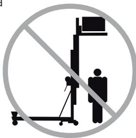
Il est interdit de rester sous la charge. La charge peut tomber d'une hauteur de 30 à 91 cm avant l'activation du blocage des colonnes par le système de freinage de sécurité. Avant d'abaisser la charge, veillez à ce que ni des personnes, ni des obstacles ne se trouvent au-dessous. Gardez les mains et les doigts à l'écart des pieds de support et d'autres pièces de la plate-forme élévatrice qui sont liées à un risque d'écrasement.
