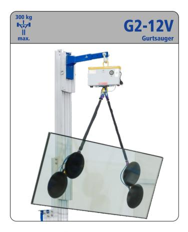
Der **Gurtsauger** verfügt über zwei Paar, jeweils starr miteinander verbundene Saugteller, die an Gurten befestigt sind. Dadurch lassen sich die Saugteller variabel positionieren und bei Bedarf an beiden Seiten einer Scheibe positionieren. Das bietet viel Flexibilität bei der Aufnahme und Justierung von Scheiben, die von oben eingesetzt werden. Damit ist der G2 bestens für das sichere Aufnehmen und Einbauen von schmalen Scheiben und Türen mit Glaseinsatz geeignet.
