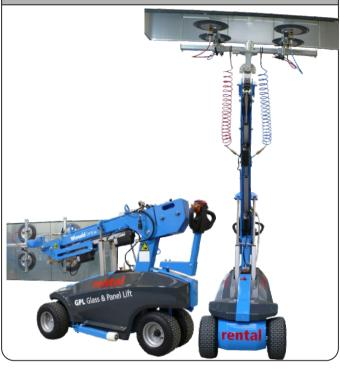
Mit dem Glass and Panellift **GPL** lassen sich Scheiben bis 420 kg transportieren und montieren. Der Selbstfahrer ist mit Luftbereifung ausgestattet, um beim Verfahren möglichst wenig Vibration auf die Scheiben zu übertragen. Die Steuerung befindet sich hinten an der Deichsel. Die Funktionen der Vakuumeinheit werden mit einer separaten Kabelfernbedienung gesteuert: Saugen, Lösen, Teleskopieren und seitlich Verschieben. Zwei seitlich ausklappbare Ausleger tragen zu erhöhter Standsicherheit bei.
