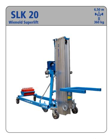
Der **SLK 20** bringt Scheiben und andere Lasten bis 360 kg auf 6,50 m Hakenhöhe. Die Ausleger des Superlifts sind rückwärts montiert und mit 8 Kontergewichten bestückt. Die großzügige Standfläche bietet hohe Stabilität. Für Einsätze im Außenbereich verfügt der SLK über seitliche Ausleger, um Windlasten aufzunehmen. Damit bietet der SLK optimale Bedingungen für das Einsetzen von schweren Scheiben sowie bei der Montage vergleichbarer Elemente im Fassadenbau.
